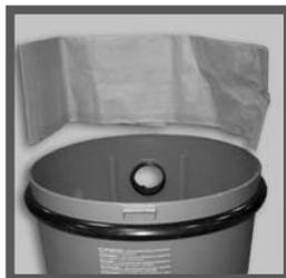
Dabar siurbimo žarnos movą galite vėl įdėti į bakelio lizdą – laikydami guminį antgalį, įdėkite movą ir pritvirtinkite ją, sukdami pagal laikrodžio rodyklę.
