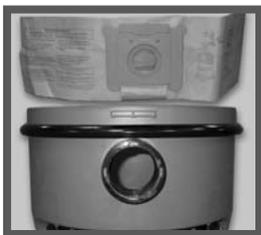
Możesz teraz zamocować nowy papierowy worek na kurz. Umieść po prostu tekturowe brzogi płytki mocującej worek w wycięciach zbiornika i wsuń worek na swoje miejsce.
