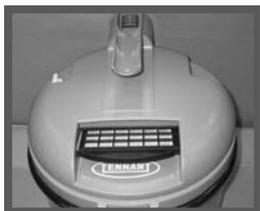
Je umístěn v horní části vysavače, v přední části víka pod rukojetí. Vytáhněte filtr tak, že pevně stisknete černý plastový zoubek/rukojeť. Otevřete rám filtru, který nyní odkryje fleece filtru. Vyměňte fleece, zavřete rámec a znovu jej vložte do vysavače. Odtahový filtr by měl být měněn každých šest měsíců.
