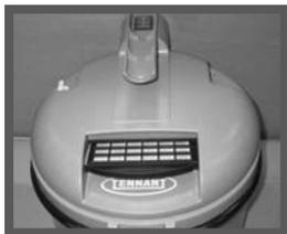
Этот фильтр размещен на верхней части машины, напротив крышки и под ручкой. Вынуть фильтр, крепко держа черную пластмассовую шпонку/ручку. Открыть проход/рамку фильтра, где сейчас виден фильтровальный покров. Заменить фильтровальный покров, закрыть рамку и вставить ее в электроприбор. Необходимо заменять всасывающий фильтр, по крайней мере, каждые шесть месяцев.
