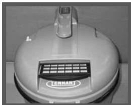
Este situat in partea superioara al aparatului, pe frontalul capacului sub manerul. Trebuie extras filtrul tinand cu putere manerul din plastic negru. Trebuie deschisa partea in forma de grilaj al filtrului, din care apare acum tesatura deasa a filtrului, se inlocuieste, si trebuie inchisa di nou aceasta parte si introdusa in aparat. Filtrul de descarcare trebuie inlocuit cel putin la sase luni.
