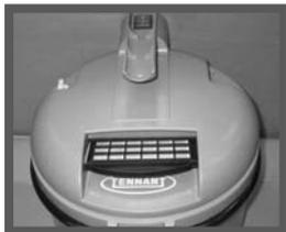
Nahaja se na vrhu stroja, nasproti pokrova, pod ročajem. Filter povlečete ven tako, da tesno držite črni plastično ploščico/ročaj. Odprete vrata/okvir filtra, kjer je sedaj viden vrhnji kosmati del filtra. Kosmati filter zamenjate, zaprete okvir in ga ponovno vstavite v stroj. Filter izpušnega zraka je treba zamenjati vsaj vsakih šest mesecev.
