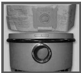
Az új szűrőzsák ezennel behelyezhető. Egyszerűen helyezze be a papírszák illesztőlemezeinek kartonból készült széleit a tartály megfelelő bevágásaiba, és csúsztassa le a zsákot a helyére.
