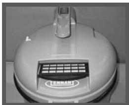
Ez a gép felső részén található, a fogantyú alatti burkolat elején. Húzza ki óvatosan a szűrőt, határozottan fogva a fekete műanyag fület/fogantyút. Nyissa ki a szűrőkaput/keretet. Ezzel láthatóvá válik a szűrő anyaga. Cserélje ki az anyagot, zárja le a keretet és helyezze vissza a gépbe. A légekimeneti szűrőt legalább félévente kell cserélni.
