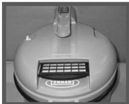
Tas ievietots mašīnas galā, priekšā pārkļājam zem roktura. Velciet filtru uz ārpusi aiz stingrā turētāja, kas ir virs melnās plastmasas cilpas/roktura. Atveriet filtra eju/rāmi, kur atklājas vilnas filtrs. Nomainiet vilnu, aizveriet rāmi un atlieciet to mašīnā. Izplūdes filtru vajadzētu nomainīt ne vēlāk kā ik katrus 6 mēnešus.
