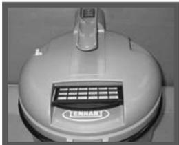
Nachádza sa na vrchnej strane prístroja, vedľa krytu pod rukoväťou. Filter vyťahnite tak, že ho pevne uchopíte za čiernu plastovú úchytku. Otvorte rámik filtra, ktorí vám poodhalí flauš filtra. Vymeňte flauš, zatvorte rámik a opätovne ho vložte do prístroja. Sací filter by sa mal vymieňať každých šesť mesiacov.
